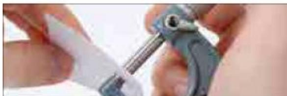
5. A titre d'entretien quotidien, éliminez la poussière, les copeaux et autres impuretés de la circonférence et des faces de mesure de la broche. Essuyez convenablement l'instrument avec un chiffon sec pour éliminer les taches et les traces de doigts.
