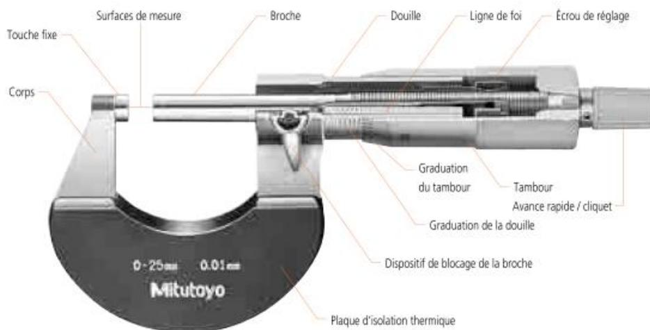
Fig I.5 – Micromètre d'extérieur analogique standard.
